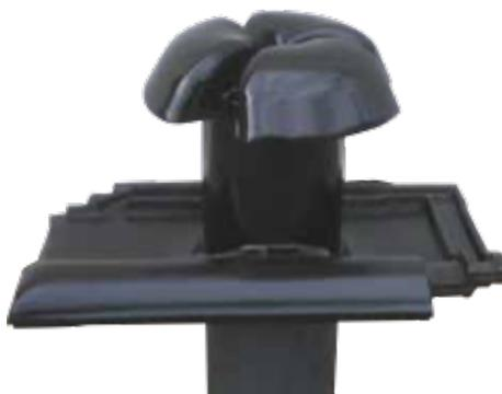
Der Rhedach Steildachs sanitürlüfter Plus mit abnehmbarer Wetterkappe ist zum Eindeckmaterial passend in den Größen DN 100 sowie DN 125 mm lieferbar. Die angegebenen Rohrdurchmesser entsprechen den DIN Größen der handelsüblichen HT-Rohre. Das Rohr ist rechtwinklig im Eindeckmaterial eingearbeitet und passt somit zu jeder Dachneigung. Der Durchgang wird aus einem original Ziegel-/Betondachsteinmodell mit einem farblich abgestimmten PVC Durchgang gefertigt.
