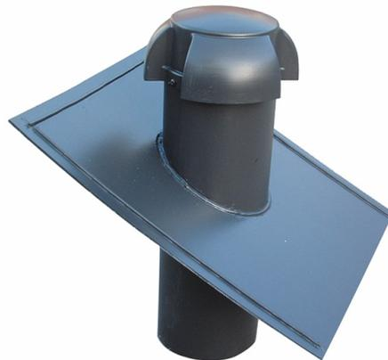
Der Rhedach Hart-PVC SanitÄrlüfter für Schiefer- und Schindeleindeckung wird in DN 70, 100 und 125 mm passend zum Eindeckmaterial mit einer Grundplatte, Größe 400 x 400 mm geliefert.
