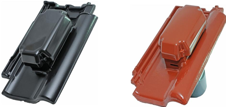
Der Rhedach Steildachsantilüfter Rechteck mit abnehmbarer Wetterkappe ist zum Eindeckmaterial passend lieferbar. Der Anschluss unterhalb der Ziegel ist rund in DN 125 und entspricht den DIN Größen der handelsüblichen HT-Rohre.
