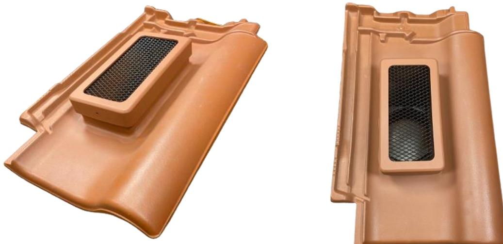
Der Rhedach Steildachsaniärlüfter PV + wird mit einer sehr geringen Aufbauhöhe gefertigt. Somit kann er unter einer PV-Anlage installiert werden und bietet dennoch die Funktion der Entlüftung des Sanitärstrangs. Er ist zum jeweiligen Eindeckmaterial passend lieferbar. Der Anschluss unterhalb der Ziegel ist rund in DN 125 und entspricht den DIN Größen der handelsüblichen HT-Rohre.
